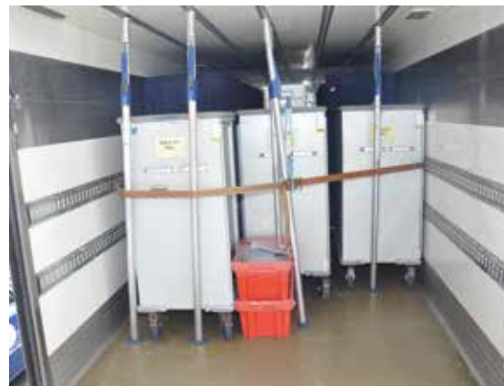
Foto n. 2 Sistema di fissaggio nel vano di carico del camion (rif. Tiziano Balmelli).
